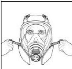
2. Tirer les extrémités des quatre sangles afin d'ajuster le serrage. Ajuster en premier lieu les sangles au niveau de la nuque, puis au niveau du front. Ne pas serrer trop fortement les sangles.
