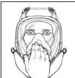
3. À chaque mise en place du masque complet, vérifier l'étanchéité par pression positive et/ou négative.
